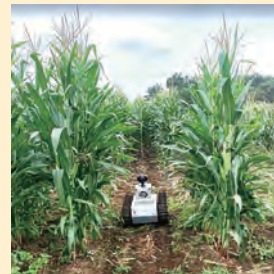
水田や畑におけるドローンやローバーによる全自動フェノタイプング技術の開発(生育調査、雑草管理等)
